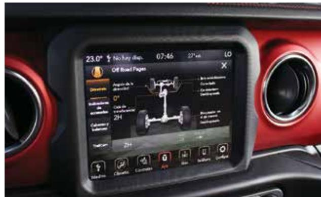
Es el único Jeep que incorpora un modo de manejo Off Road +, que funciona con tracción trasera y diferencial bloqueado para hacer rutas en terracería a alta velocidad.
