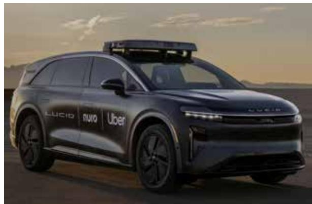
La alianza presentó un robotaxi diseñado específicamente para la operación autónoma a gran escala. Basado en el Lucid Gravity, integra un conjunto de sensores de nueva generación, cámaras de alta resolución, lidar de estado sólido y radares, que permiten una percepción de 360 grados, integrados directamente en la carrocería del vehículo.
